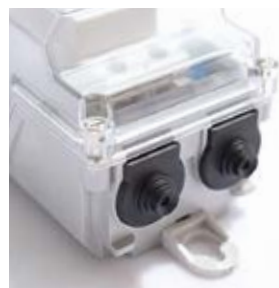
▲ Auch auf der Abgangsseite bieten wir Ihnen 2 bis 4 Standardöffnungen (mit Stufentüllen und Kabelverschraubungen) sowie die Möglichkeit, in der Stirnplatte individuelle Öffnungen einzubringen.
