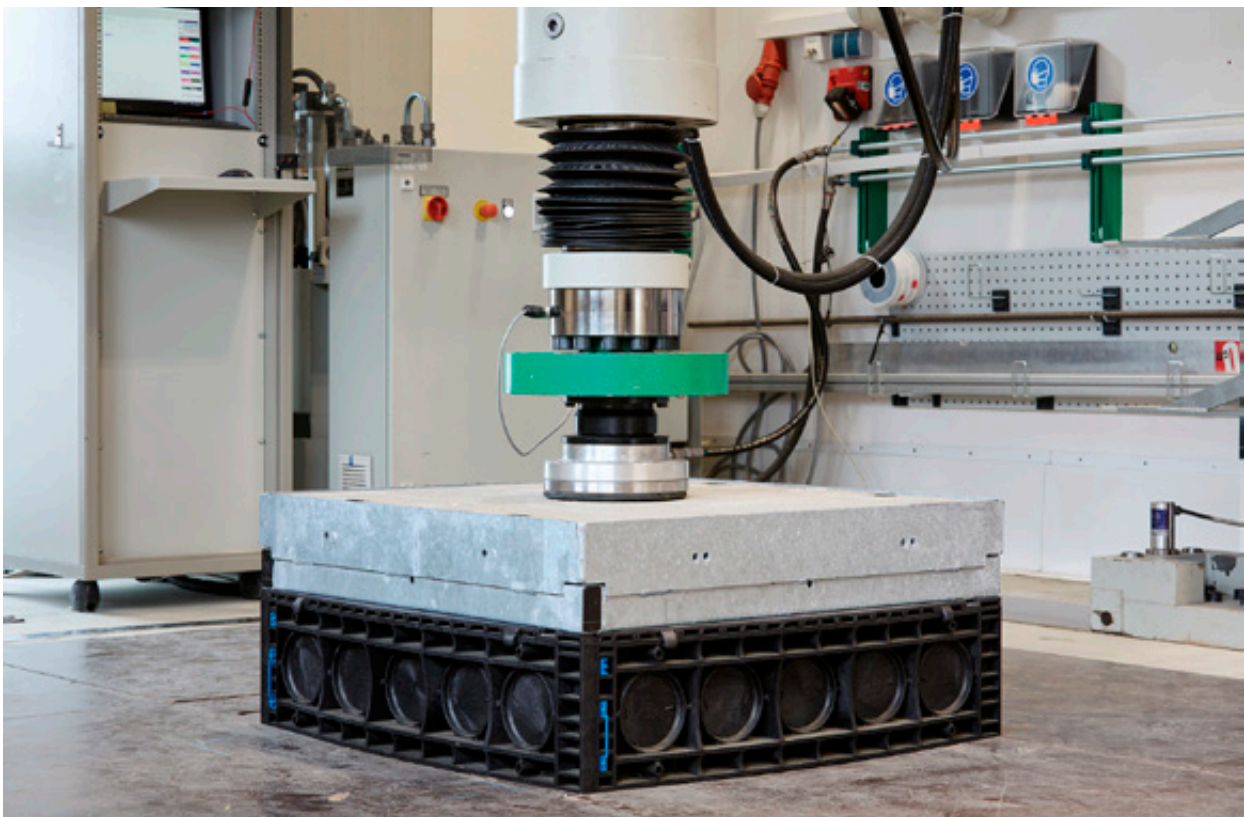
▲ Prüfung der Belastungsklasse bei Langmatz in Garmisch-Partenkirchen
