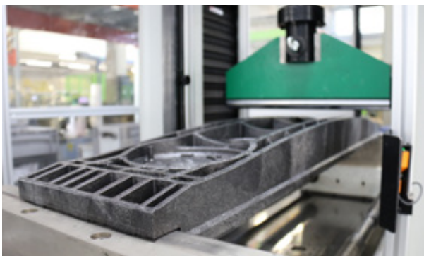
▲ 3-Punkt-Prüfpresse bei Langmatz in Oberau
